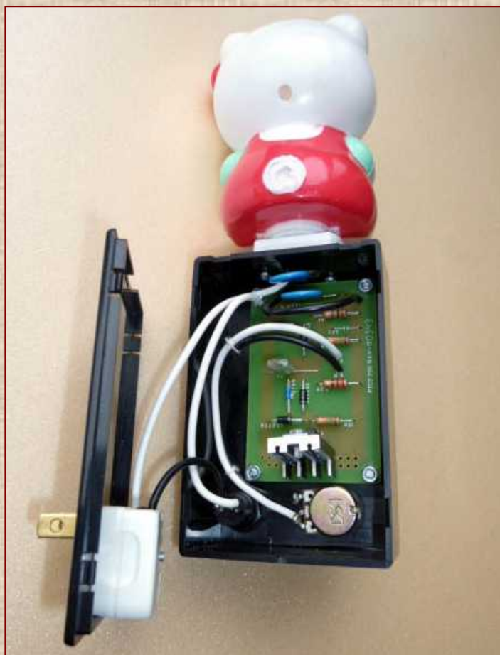
一応小さいヒートシンクも取り付け付けた（ナイトライトの使用が 終わったら他に転用したいので・・・）
