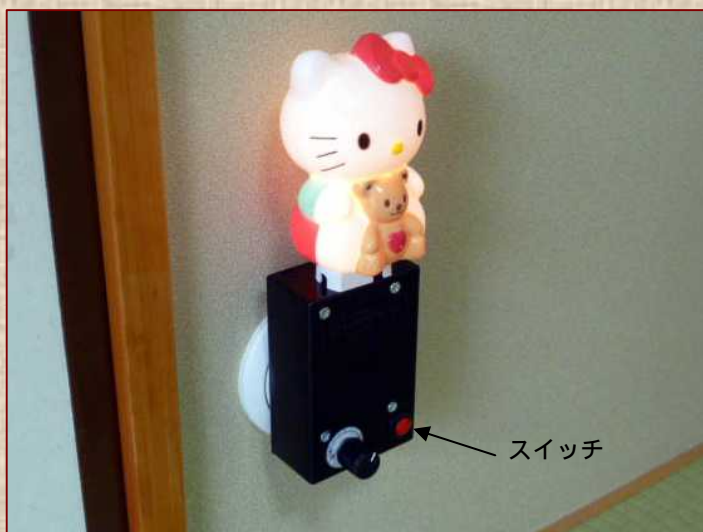
コンセントに挿して点灯したところ (小さいオルタネート SW だが、案外操作し易い)
